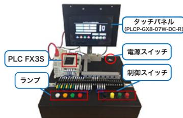
PLC (programmable logic controller) とは機械を自動的に制御する装置のことで、あらかじめ決めた順序で機械の制御を進めていくものです。工場などで自動機械の制御に使われています。
